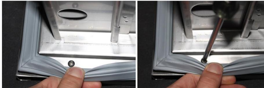
**Schritt 3:** Heben Sie nun den Ladenkasten samt Innenblende von der Außenblende ab und legen Sie den rosafarbenen Isolierstreifen zur Seite. Nachdem Sie die Niro-Klemmleiste von der Oberseite der Innenblende abgenommen haben, können Sie die alte Dichtung abziehen.
