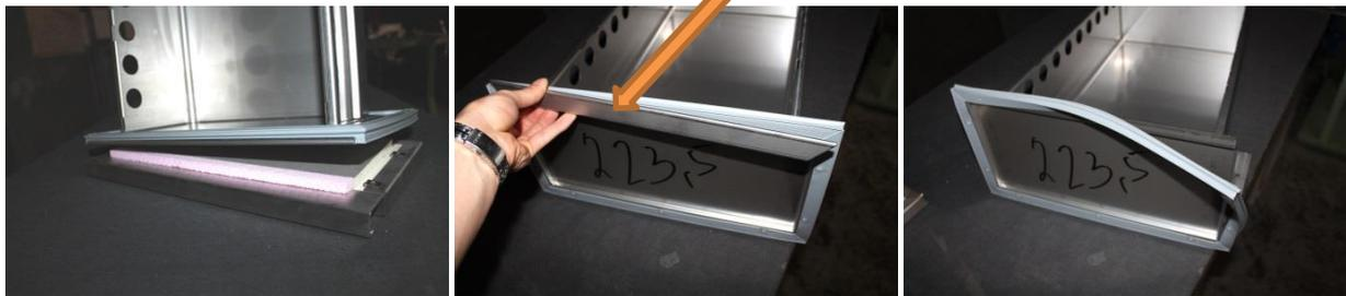
**Schritt 4:** Nun montieren Sie die neue Dichtung auf der Ladeninnenblende
